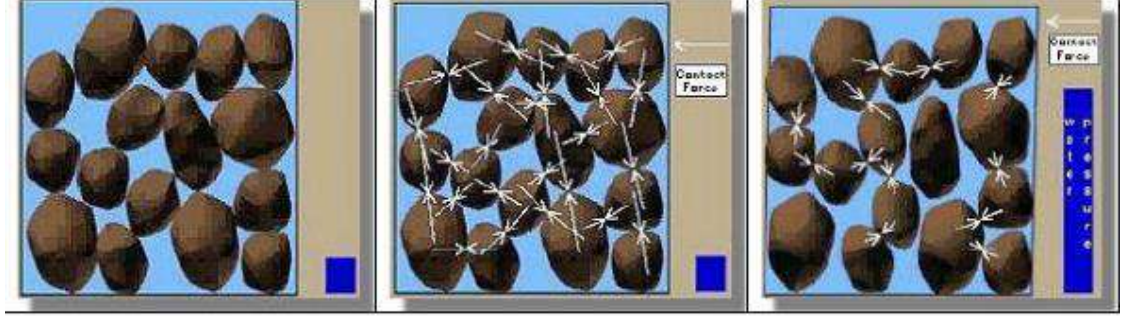
Şekil 2. Suya doymun zemin tanecikleri arasındaki bağlantı kuvvetinin deprem etkisi ile azalışı (Alpaslan, 2013)
