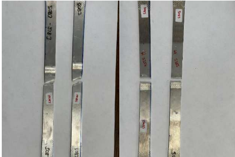
Şekil 3. Çekme deneyi sonucu elde edilen numunler.
